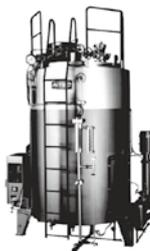
永遠の名機ヘンシェルボイラをNTECが21世紀バージョンに、大幅モディファイいたしました。高効率、大容量、高負荷耐力、高乾き度など小型貫流ボイラにない付加価値を持つNTECの新提案対応ボイラです。
